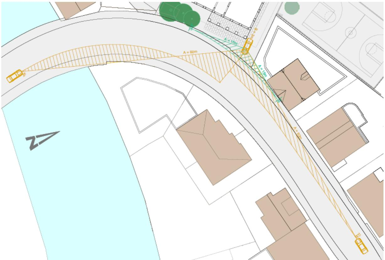
Abbildung 6: Überprüfung Knotensichtweiten Ausfahrt Entlebucherstrasse für 50 km/h
